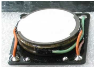
Dimensionnement de Transformateur (Ex 10W diamètre 26mm)
